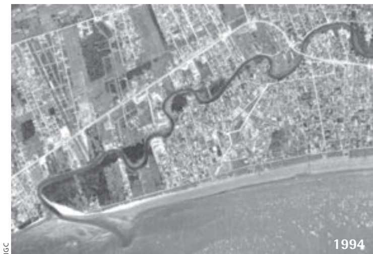
Figura 30b. Foz do rio Juqueriquerê em 1994 (escala 1:25.000). As modificações feitas no vale do rio Juqueriquerê modificaram a dinâmica do rio. Estas mudanças junto àquelas feitas na linha de costa trouxeram erosão na linha de costa como aquela vista na figura 30c.
