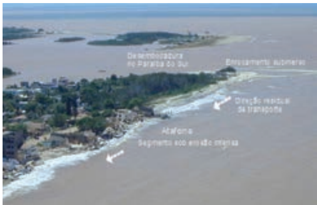
Figura 7. Segmento impactado pela erosão em Atafona, imediatamente a sul da desembocadura do Paraíba do Sul. Observa-se, na extremidade do pontal, um aparente prolongamento do mesmo por efeito de um enrocamento submerso colocado para proteger a margem do rio. A posição do enrocamento atesta a amplitude do recuo da linha de costa ao mesmo tempo que passou a exercer o efeito de um espigão impedindo o deslocamento de sedimentos em direção ao segmento sob erosão.
