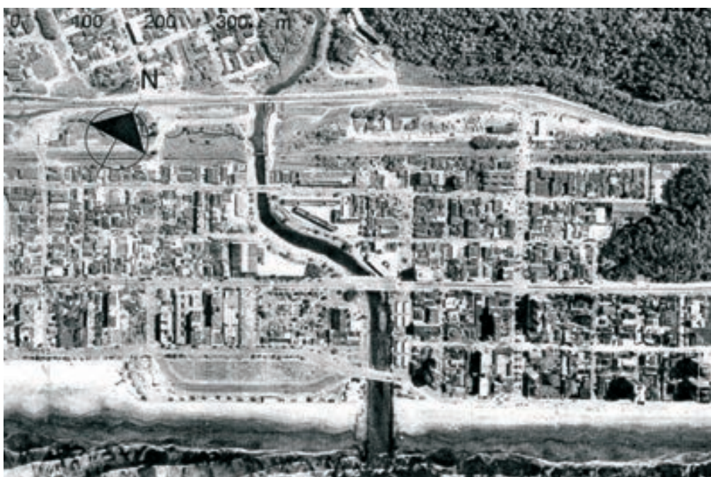
Figura 26b (abaixo). Vale do rio Mongaguá em 1997 (escala 1:10.000 – Araújo, 2000) totalmente urbanizado com o rio canalizado. A desembocadura é marcada por um molhe fixo, que não permite mais a migração desta.
