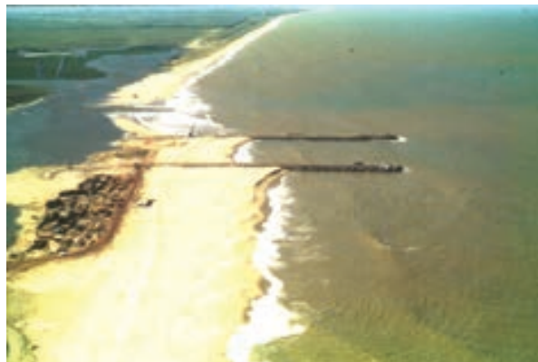
Figura 6. O canal do Furado com a retenção dos sedimentos a Sul dos guia-correntes e erosão pronunciada a Norte
