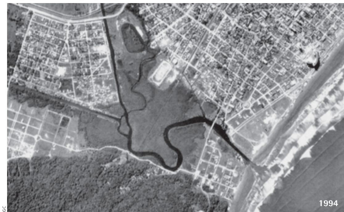
Figura 20b. Foz do rio Peruíbe em 1994 (escala 1:25.000). Os afluentes estão canalizados, o que aumentou a vazão de água sobretudo em época de chuvas. As margens do rio foram revestidas por gabiões, o que inibiu a formação das pelotas lamosas (Giannini, 1987). A ocupação acompanhada de desmatamento causou forte assoreamento na foz do rio que hoje permite a entrada somente de pequenos barcos de pesca.
