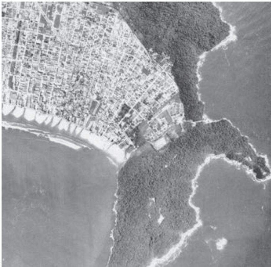
Figura 27a. Ponta do Itaipú, município de Praia Grande, em 1994 (escala 1:25.000). O sentido de deriva da Praia Grande tem resultante NE (Ponçano, 1976 e Ponçano et al., 1995), embora este dado seja confrontado por Araújo (2000). De qualquer modo, o embasamento cristalino aqui funciona como uma barreira de represamento de sedimentos.
