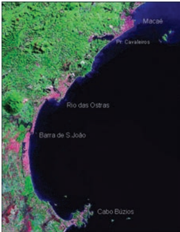
Figura 10. Compartimento Macaé ao cabo Búzios. Observar as manchas azul claras indicando transporte de material em suspensão em direção ao sul.
